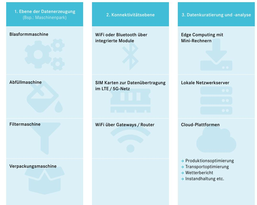
Abbildung 15: Ebenen der Datenverarbeitung am Beispiel eines Maschinenparks (1)
